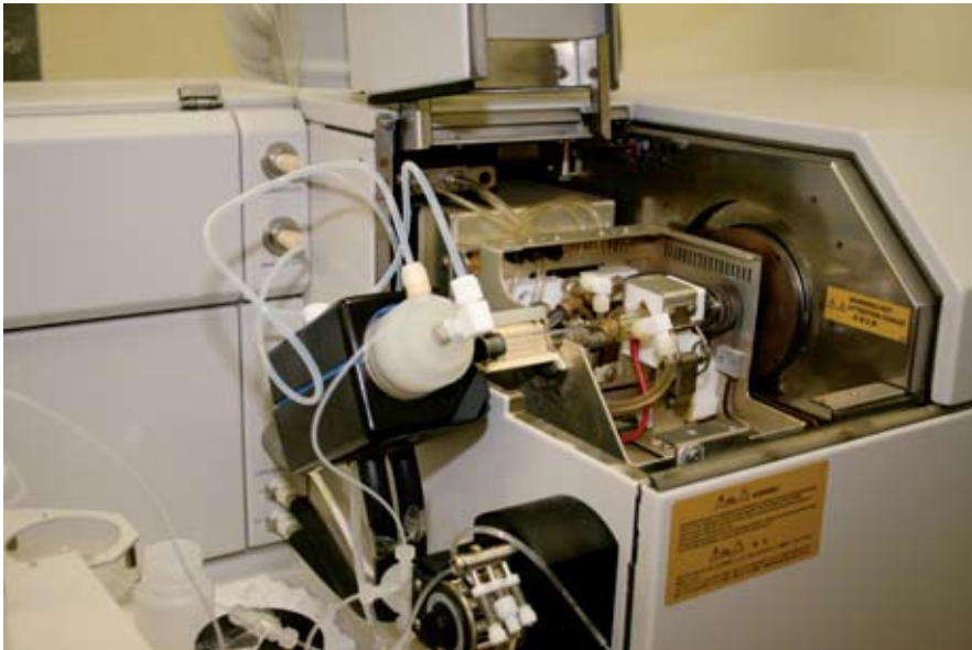
Figura 29: Espectrómetro atómico de masas AGILENT 7500C (ICP-MS).
