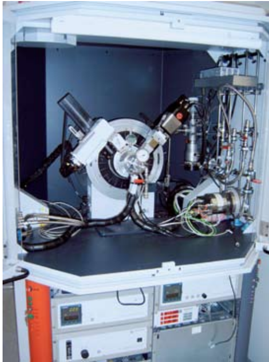
Figura 30: Difractómetro de Rayos X modelo D8Advance de BRUKER con Cámaras de alta y baja Temperatura de Anton Paar.
