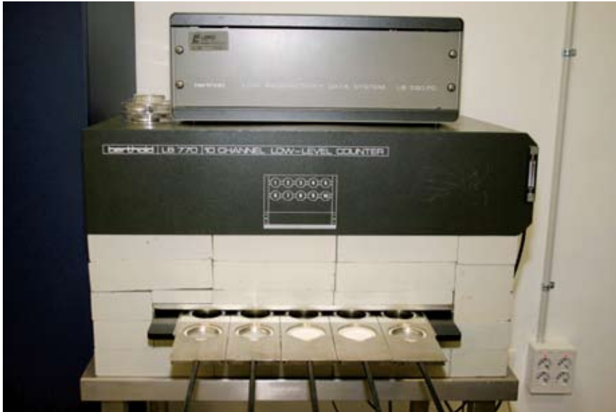
Figura 28: Detector proporcional de flujo de gas BERTHOLD 770.
