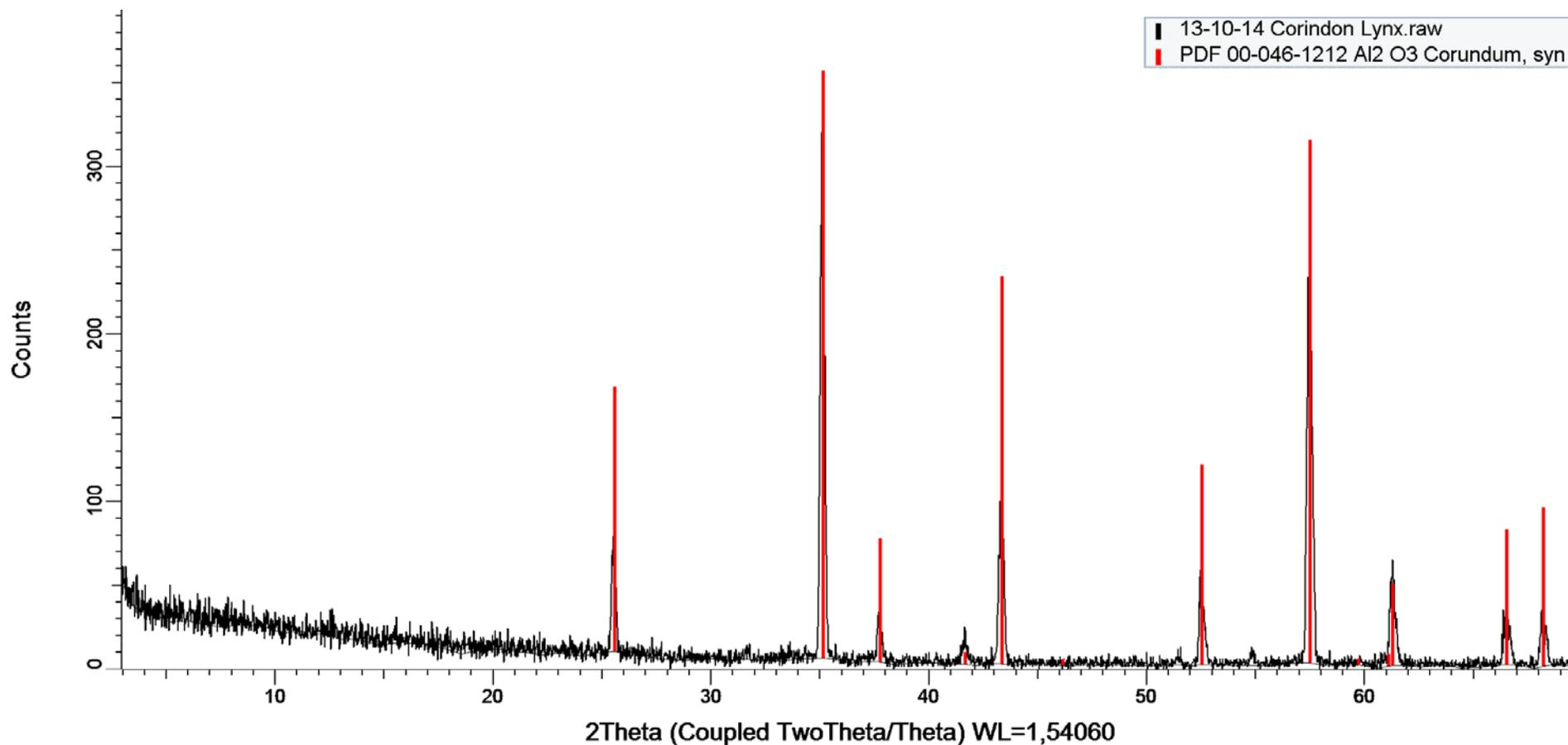
☒ CORINDON 14-10-13. Barrido tipo  $\theta$ - $2\theta$ . Rango: 3 a 70  $^{\circ}2\theta$ . Paso: 0,02  $^{\circ}$ . Tiempo por paso: 0,1 seg. Detector: LynxEye. Ánodo de Cu. Montel.
