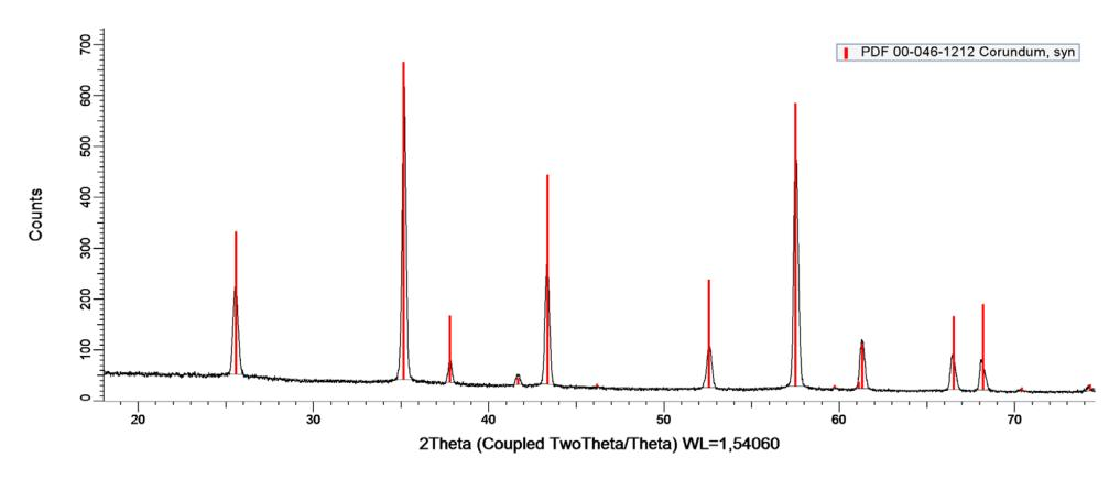
CORINDON 29-04-15. Barrido tipo Θ-2Θ. Rango: 20 a 60 °2Θ. Paso: 20 °. Tiempo por paso: 60 seg. Detector: Vantec-500. Ánodo de Cu. Montel.
