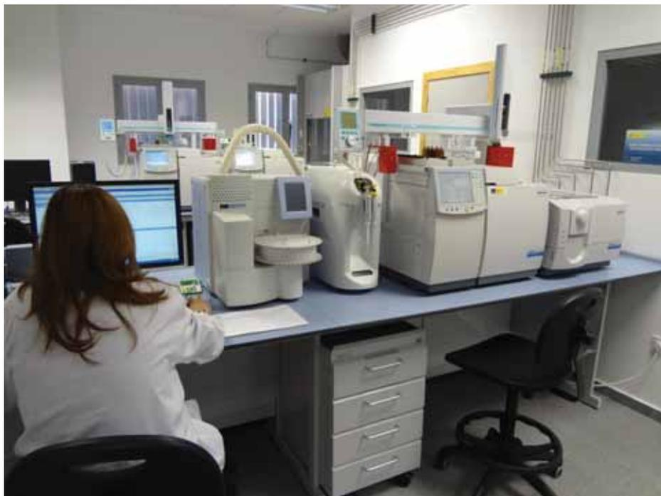
Figura 77: cromatógrafo de gases con detector de masas de triple cuadrupolo, desorción térmica y purga y trampa
