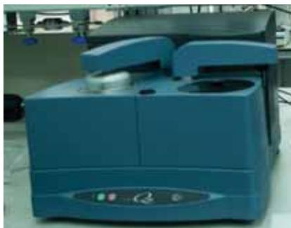
Figura 39: Calorímetro diferencial de barrido (Q20 DSC)
