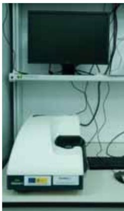
Figura 35: Analizador de Potencial Z (Zetasizer Nano ZS)
