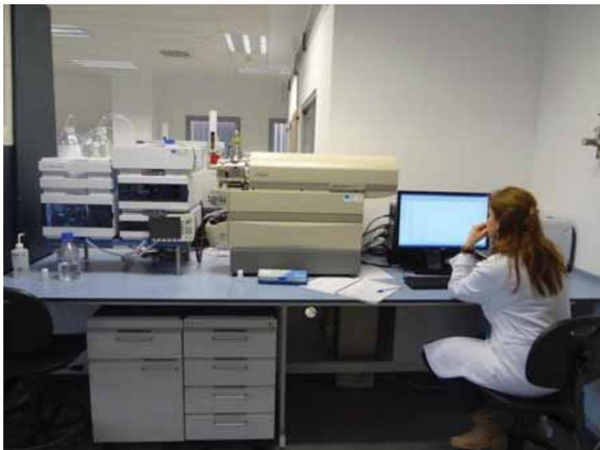
Figura 78: Cromatógrafo líquido con detector de triple cuadrupolo
