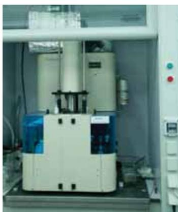
Figura 41: Porosímetro de mercurio (Pore Master 60 GT)
