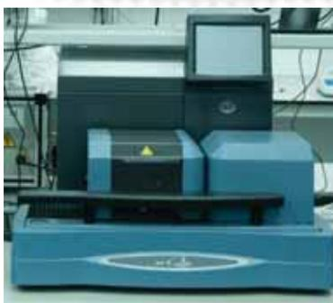
Figura 40: Termogravimétrico y Calorímetro diferencial de barrido (Q600 SDT)
