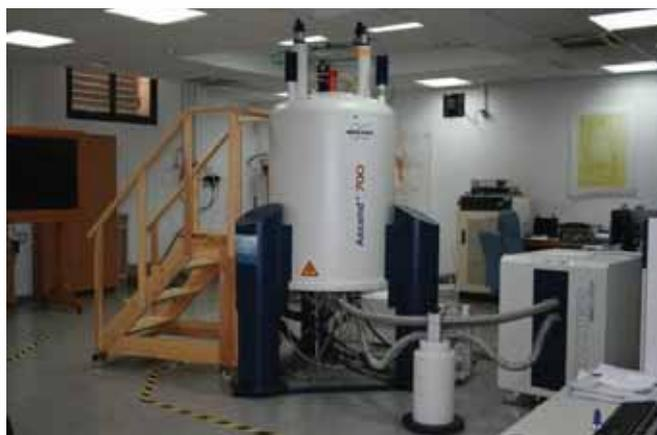
Figura 84: Espectrómetro Bruker Avance III 700 MHz
