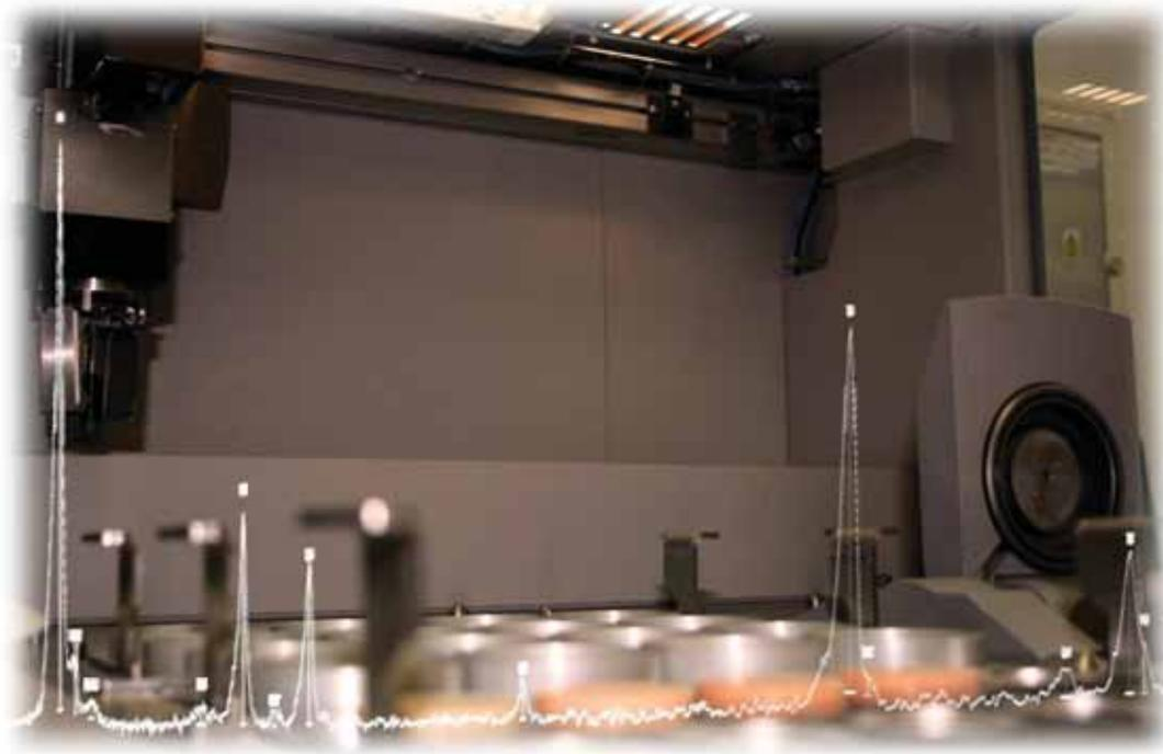
Figura 71: Espectrómetro de fluorescencia de Rayos X de PANanalytical modelo AXIOS
