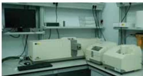
Figura 34: Analizador de Tamaño de Partículas (Mastersizer 2000)
