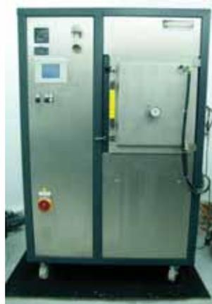
Figura 38: Horno de Vacío (Navertherm VHT 08/22 GR)
