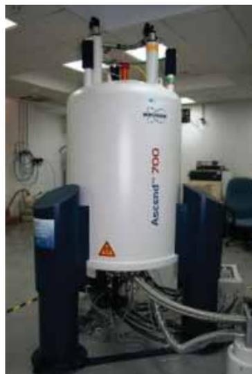
Espectrómetro de RMN Bruker, mod. Avance III 700 MHz.
