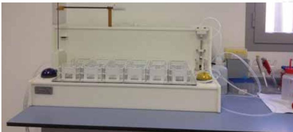
Figura 79: Autodiluidor QPREP
