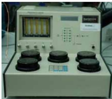
Figura 44: Picnómetro de Helio (Pentapycnometer 5200e)
