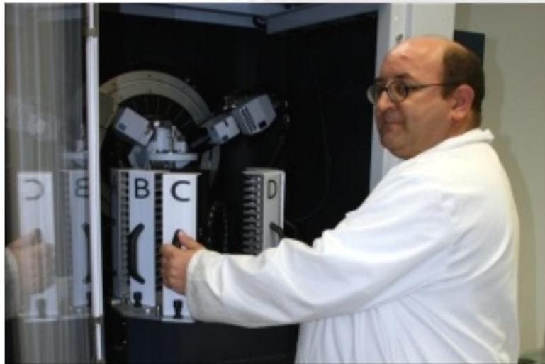
Figura 51: Francisco Rodríguez Padial, técnico del SGI-LRX intercambiando muestras en el Difractómetro de polvo Bruker modelo D8 Advance A25 (D8I-90).
