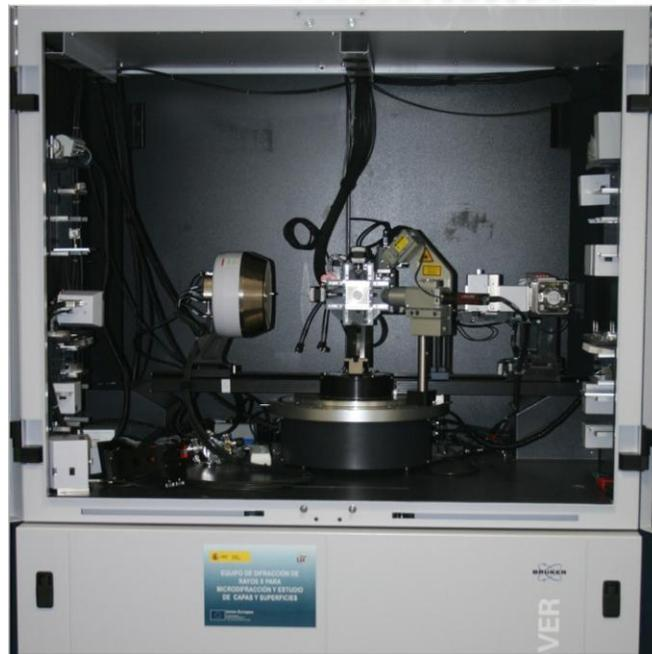
Figura 53: Difractómetro para estudio de capas y superficies modelo modelo D8 DISCOVER de la marca Bruker.
