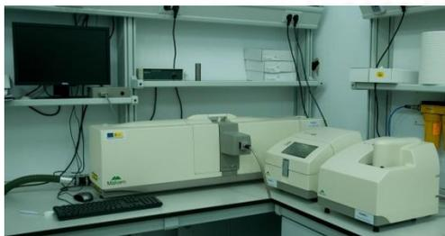
Figura 28: Analizador de Tamaño de Partículas (Mastersizer 2000)
