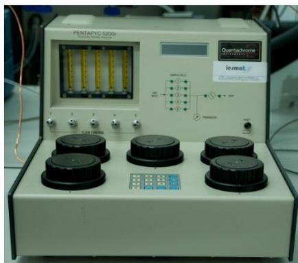
Figura 38: Picnómetro de Helio (Pentapycnometer 5200e)
