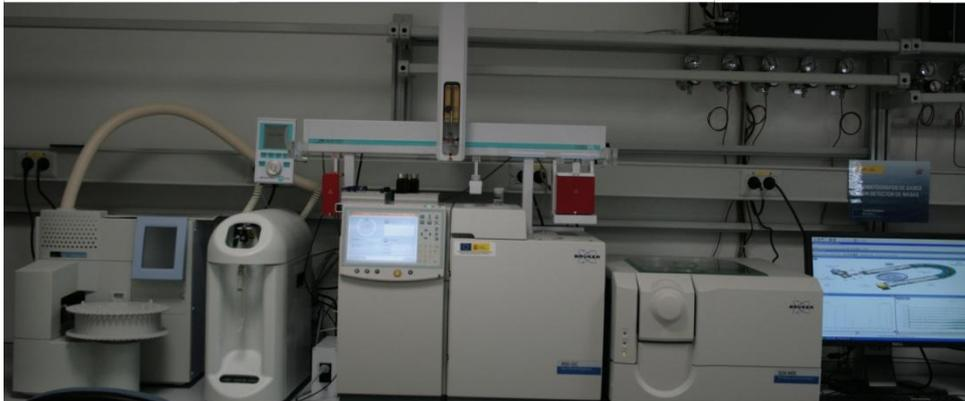
Figura 43: cromatógrafo de gases con detector de masas de triple cuadrupolo, desorción térmica y purga y trampa.
