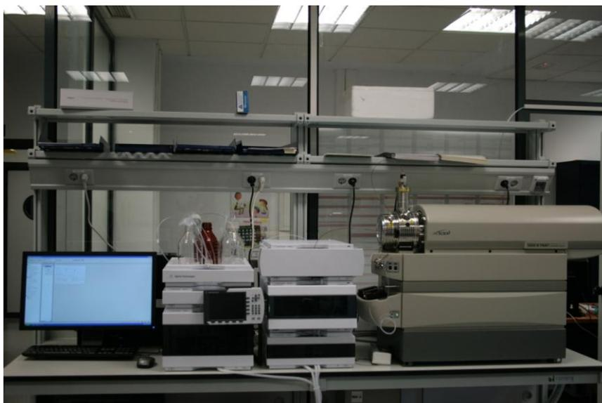
Figura 44: Cromatógrafo líquido con detector de triple cuadrupolo.
