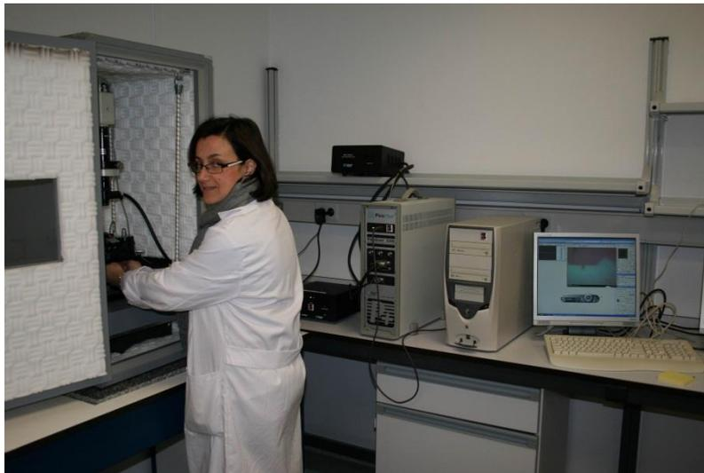
Figura 45: Consuelo Cerrillos, Titulada Superior de Apoyo a la Docencia e Investigación, en el microscopio de fuerza atómica/efecto túnel Molecular Imaging, Agilent PicoPlus 2500.
