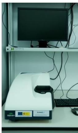
Figura 29: Analizador de Potencial Z (Zetasizer Nano ZS)
