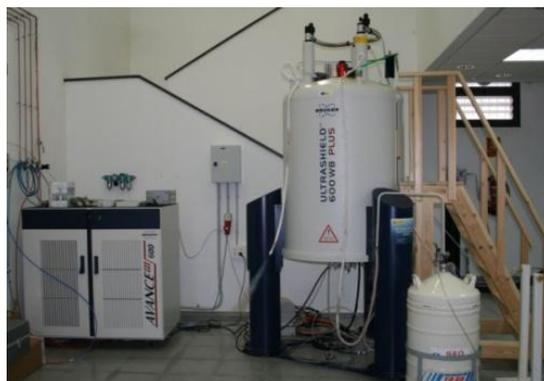
Figura 54: Detalle del espectrómetro Bruker Avance-600 WB de Sólidos
