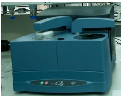
Figura 33: Calorímetro diferencial de barrido (Q20 DSC)
