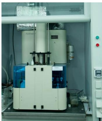
Figura 35: Porosímetro de mercurio (Pore Master 60 GT)
