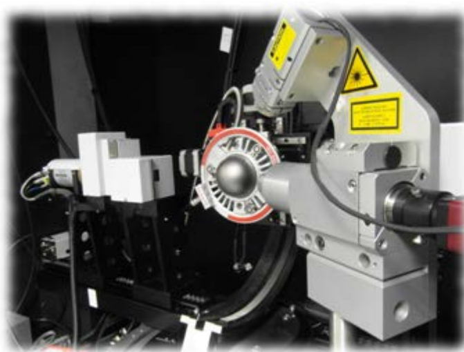
Figura 5: Difractómetro modelo D8 DISCOVER de la marca Bruker.
