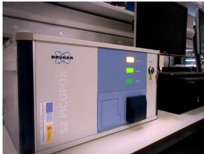
Figura: Espectrómetro de fluorescencia de Rayos X por reflexión total S2 PICOFOX .
