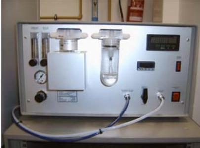
**Controlador de humedad SYCOS H para el equipo de difracción con cámaras D8C**
