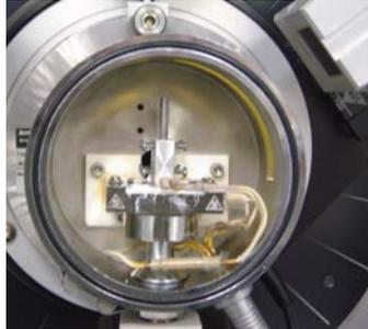
**Portamuestras de transmisión para la cámara TTK450 del equipo D8C**
