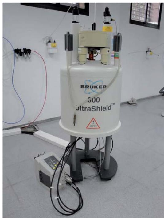
Figura 35: Detalle del espectrómetro Bruker Avance-300.
