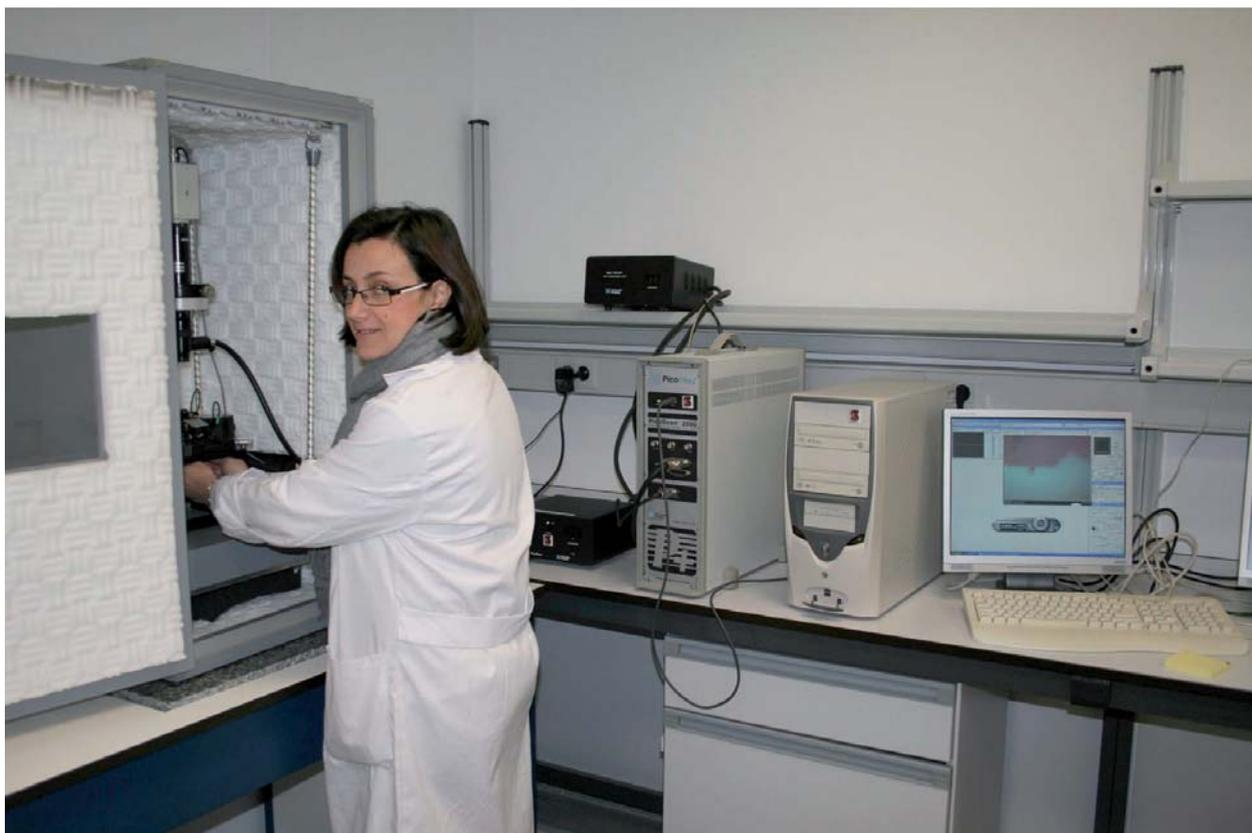
Figura 29: Chelo Cerrillos, técnico de laboratorio, en el Microscopio de fuerza atómica / efecto túnel Scientec PicoSPM II.
