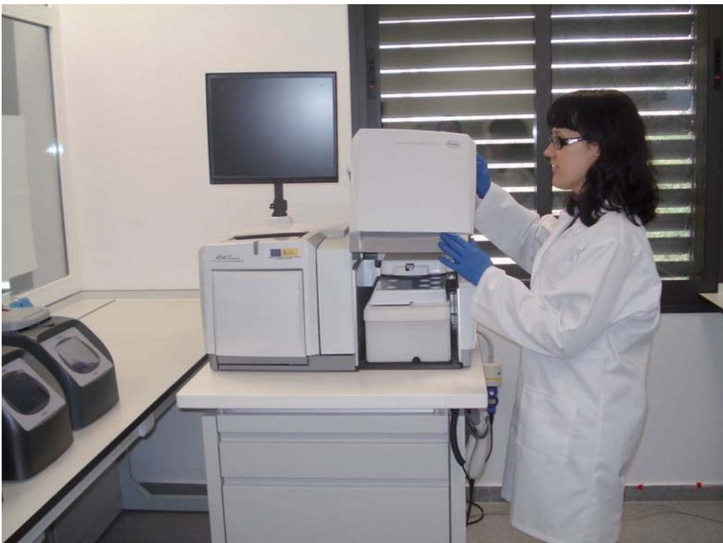
Figura 23: Laura Serrano, tec. de laboratorio del SGI BIO trabajando con el Secuenciador de ADN (Pirosecuenciador "Genome Sequencer FLX System 454 ROCHE").
