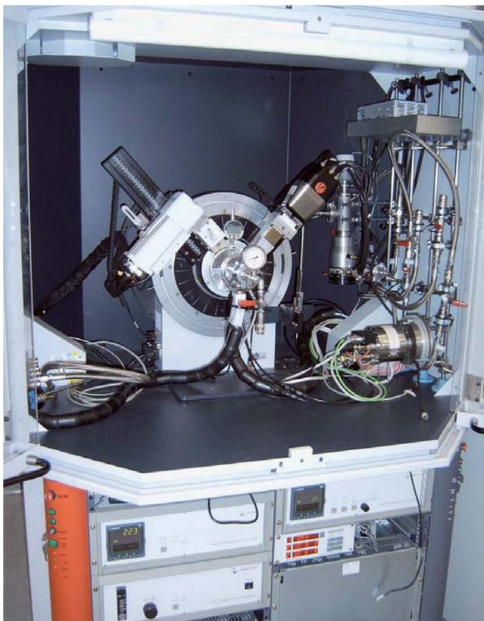
Figura 34: Difractómetro de Rayos X modelo D8Advance de BRUKER con cámaras de alta y baja temperatura de Anton Paar.
