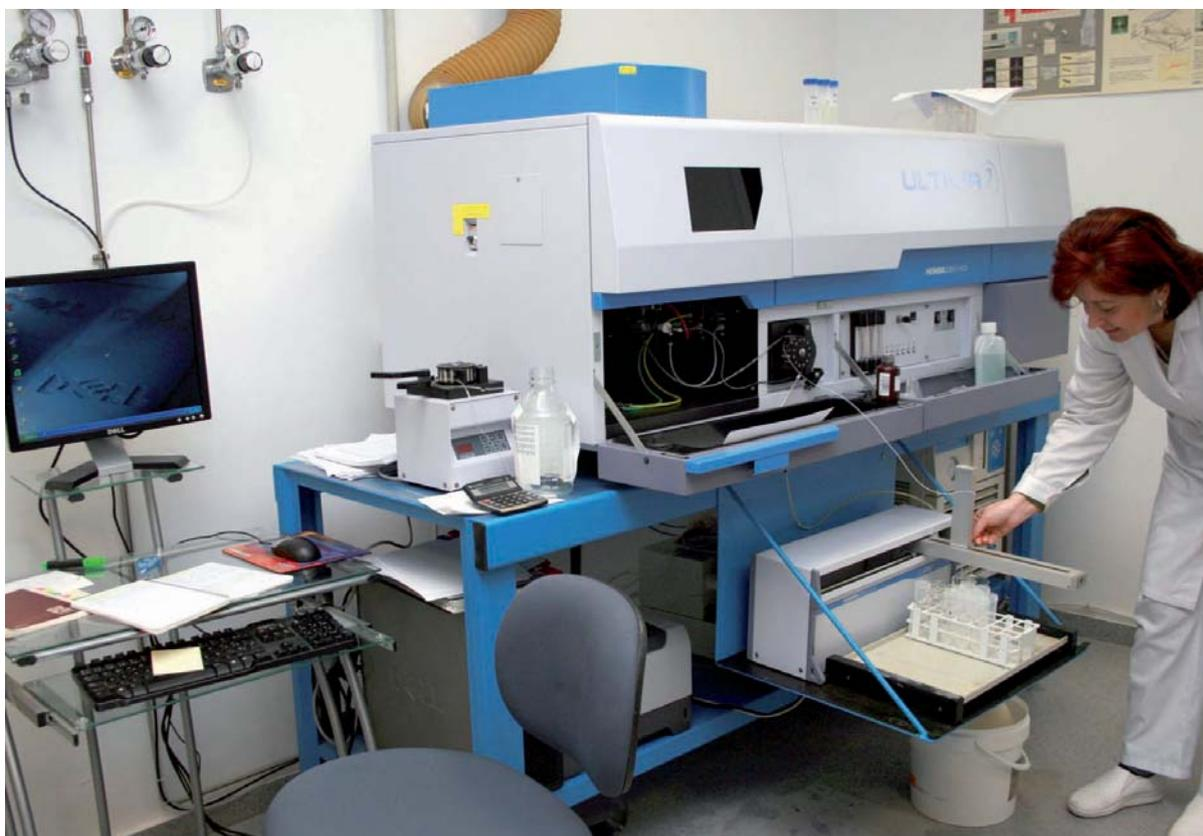
Figura 27: Chari Toledano, tec. de laboratorio del SGI MCA, colocando muestras en el ICP-óptico
